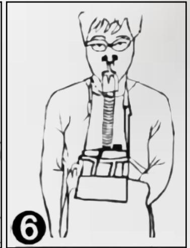
(6). Tape sus fosas con las pinzas, continúe exhalando, coloque y ajuste las monogafas. Respire or la boca uniformemente y evacúe de manera segura e inmediata.
