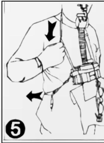
(5). Desconecte el tapón protector del tubo respiratorio, y coloque la boquilla del tubo respiratorio entre los dientes, proceda a respirar por la boca.
